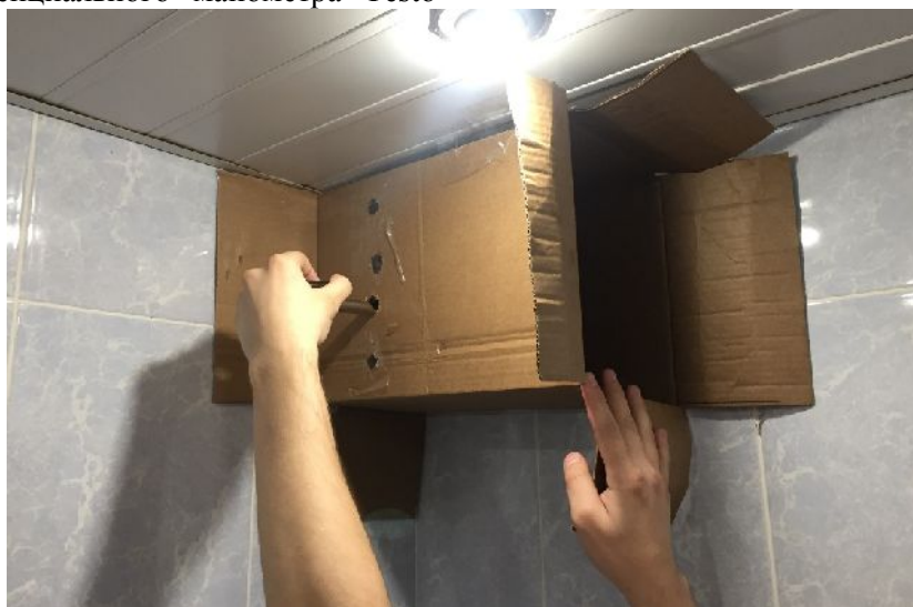
Рис. 1. Измерение расхода воздуха с помощью измерительного насадка
