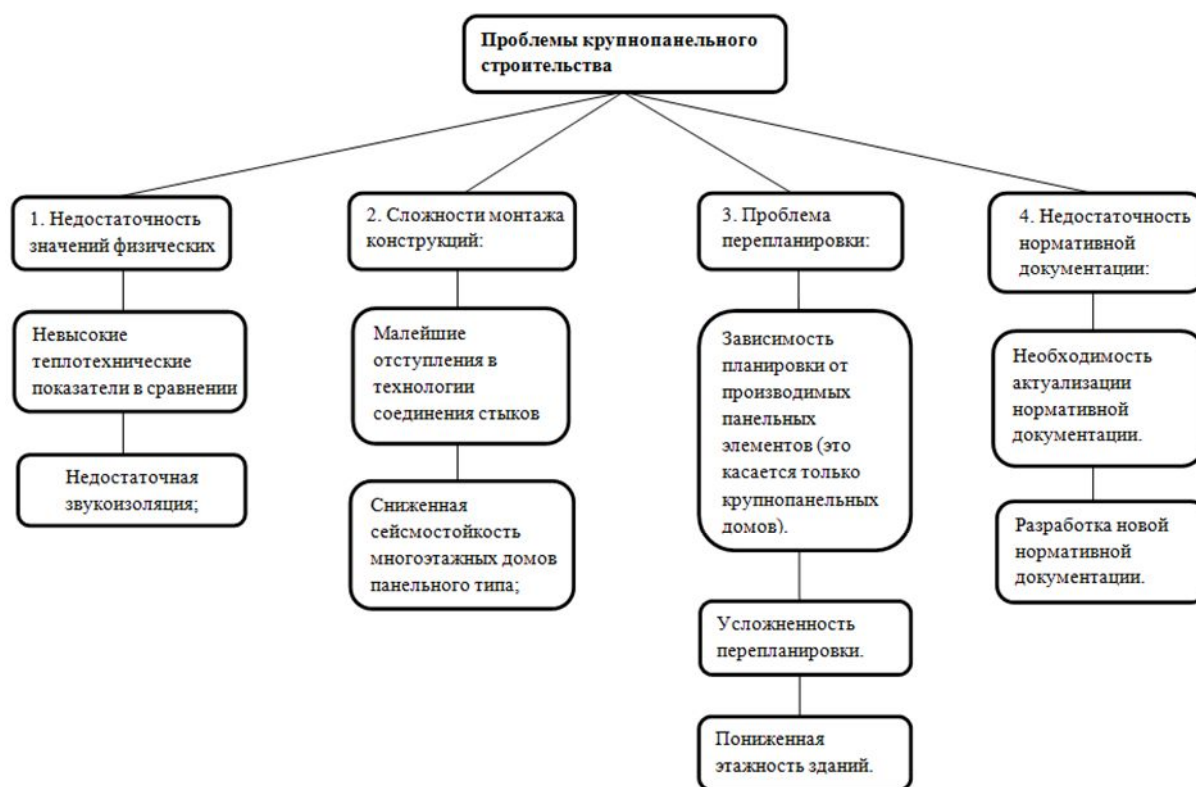
Рис. 1. Ранжирование проблем крупнопанельного строительства
